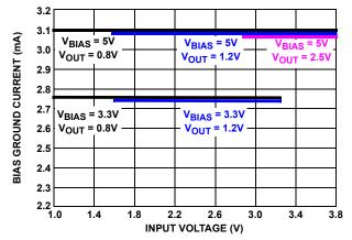
FIGURE 16. BIAS GROUND CURRENT vs  $\mathbf{V}_{\text{IN}}$  and  $\mathbf{V}_{\text{OUT}}$
