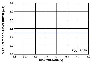
FIGURE 15. INPUT GROUND CURRENT vs  $V_{\mbox{\footnotesize BIAS}}$
