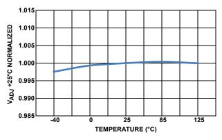
FIGURE 4. V<sub>ADJ</sub> vs TEMPERATURE
