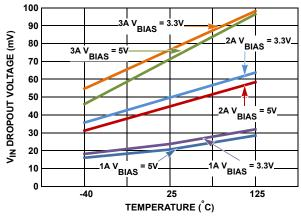
FIGURE 6. DROPOUT vs TEMPERATURE
