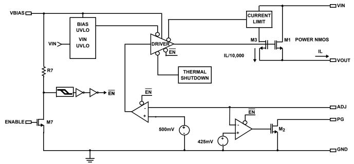
FIGURE 5. BLOCK DIAGRAM
