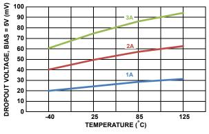
FIGURE 2. DROPOUT VOLTAGE OVER-TEMP AND  $I_{\mbox{\scriptsize OUT}}$
