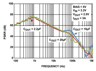
FIGURE 32. V<sub>IN</sub> PSRR vs FREQUENCY FOR VARIOUS C<sub>OUT</sub>
