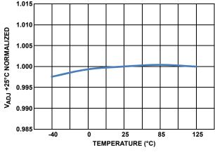
FIGURE 8. V<sub>ADJ</sub> vs TEMPERATURE
