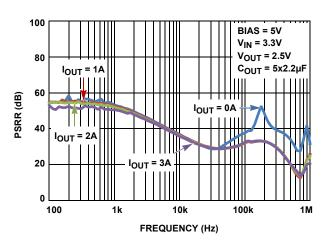
FIGURE 35. V<sub>BIAS</sub> PSRR vs FREQUENCY FOR VARIOUS LOAD CURRENTS
