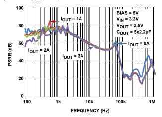
FIGURE 34. V<sub>IN</sub> PSRR vs FREQUENCY FOR VARIOUS LOAD CURRENTS
