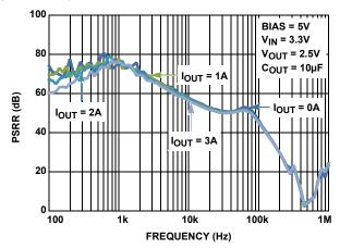
FIGURE 28. V<sub>IN</sub> PSRR vs FREQUENCY FOR VARIOUS LOAD CURRENTS
